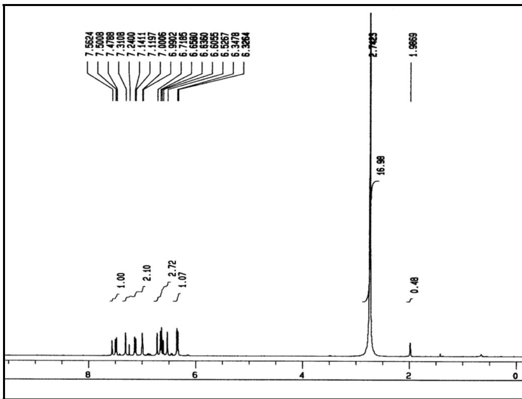
**Figure S3.**  $^1\text{H}$ -NMR (400 MHz) of ligand azim (bis-(4-imidazol-1-yl-phenyl)-diazene).
