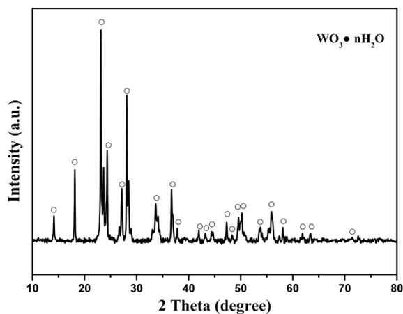
**Fig. S1** XRD pattern of  $\text{WO}_3\text{-nH}_2\text{O/GN}$ .
