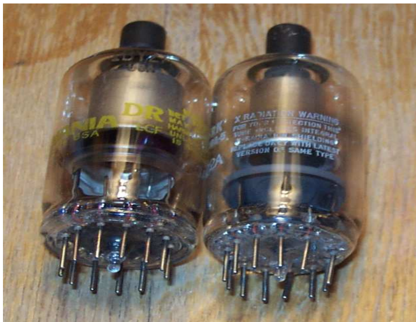
Fig. 5d Tub termoionic pentru redresare înaltă tensiune ce este capabil să producă raze X (6)
