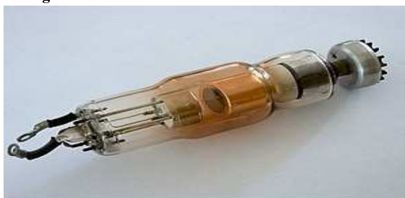
Fig. 5a Tub Coolidge classic pentru radiografii dentare (6)
